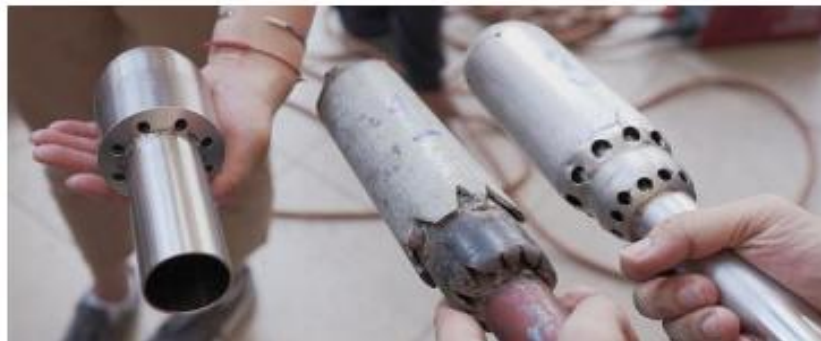
รูปที่ 9 หัวฉีดสำหรับล้างท่อแบบใหม่ (รูปซ้าย) และหัวฉีดล้างท่อแบบเดิม (ด้านขวา)
