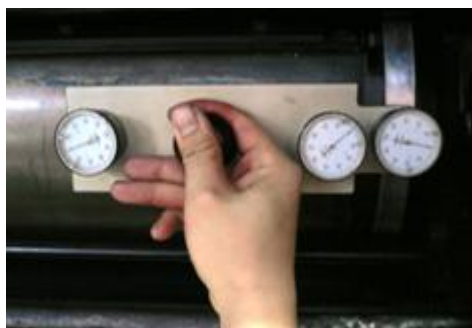
รูปที่ 14. แสดงการวัดระยะปากโมแม่พิมพ์ด้วยเครื่องมือวัดการหมุนนำเข้าจากต่างประเทศ
