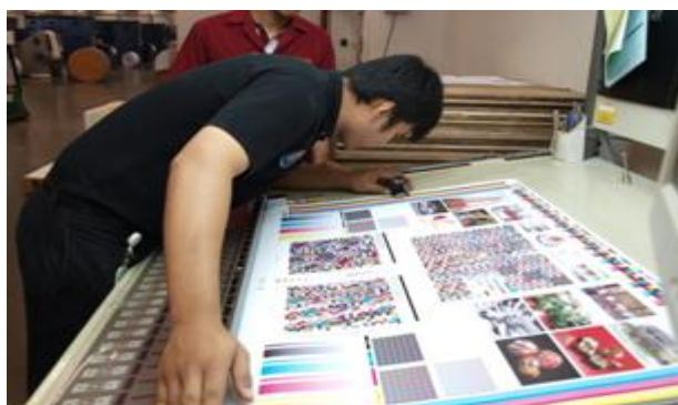
รูปที่ 18 ตรวจสอบมาร์คของผลงานพิมพ์ก่อนและหลังปรับตั้งระยะรองหนุนไม้ฝ้ายบันทึกเก็บข้อมูล
