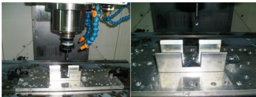
รูปที่ 7. อลูมิเนียมเกรด AL 5083 วัสดุที่นำมาขึ้นรูปเครื่องมือวัดรองหนุน (Packing Gauge)
