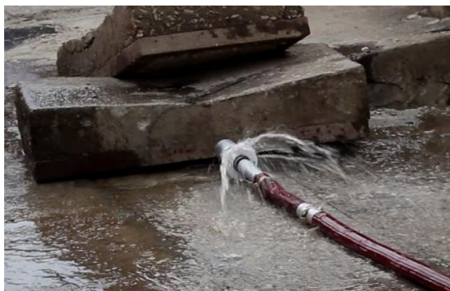
รูปที่ 10 การทดสอบหัวฉีดล้างท่อซึ่งสวมอุปกรณ์ปรับมุมของการฉีดล้าง
