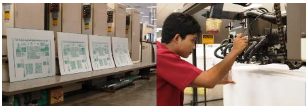
รูปที่ 17 ใส่แม่พิมพ์ 4 สี ที่สร้างสำหรับทดสอบคุณภาพงานพิมพ์กับเครื่องพิมพ์ออฟเซต มิตซูบิชิ รุ่น ไดมอนด์ 3000
