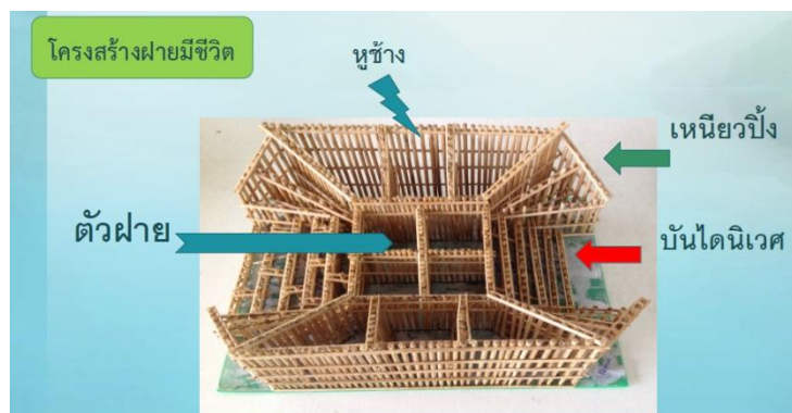
รูปที่ 1 โครงสร้างฝายมีชีวิต (ที่มา: สำนักงานสิ่งแวดล้อมภาคที่ 1, 2562)
